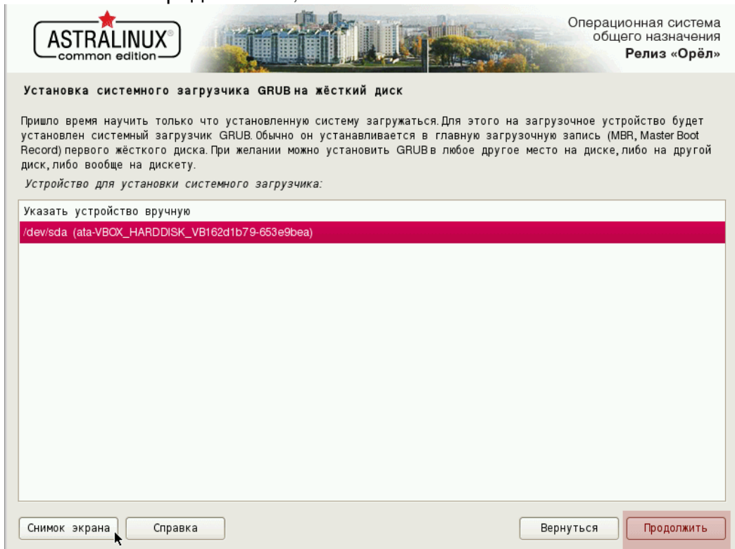
Рисунок П1.23. Подтверждение установки загрузчика GRUB на жесткий диск выбранного устройства в Окне мастера установки операционной системы Astra Linux, релиз «Орёл»
